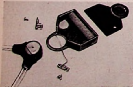
Bild 5. Gehäuse mit Deckel (Rückseite), Schalter, Batterie-Halter und geänderter Stetoclip
